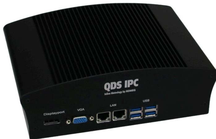
Der IPC ist die ideale Lösung für platzsparende Mess- und Steueraufgaben. Dank seiner schlanken Bauform passt er perfekt in jeden Schaltschrank und lässt sich bequem über die Hutschiene montieren. Die 24V Spannungsversorgung kann über das SPS-Netzteil erfolgen, dadurch entfällt ein zusätzliches Netzteil.
